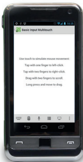
Приложение Unified Remote для Android превращает ваш телефон в устройство ввода с помощью жестов или голоса
